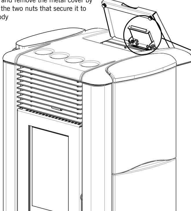
**Pour accéder aux composants électroniques du display graphique**, ouvrir le couvercle de la trémie, enlever le carter de couverture assuré au poêle par les écrous, en dévissant les mêmes.
